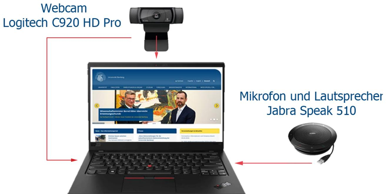
Abbildung 1 - Komponenten des Video-Pakets, ihr Aufbau und Anschluss
